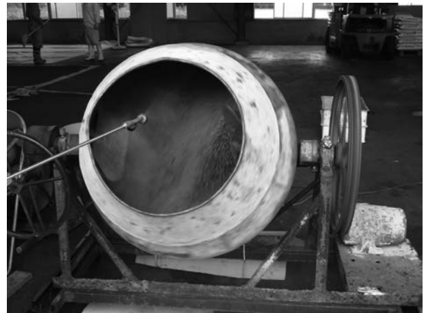
図5. コンクリートミキサーによる被覆
